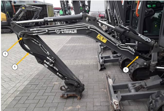
Figuur 6.21 Controle hydraulische slangen X1 en X3
