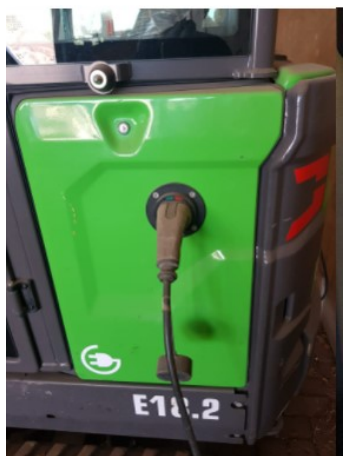
Figuur 5.2 Laadkabel ingeplugd
