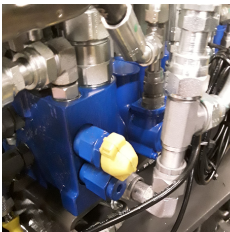
Figur 6.2 Justeringspunkt for hoved- og LS-trykk
