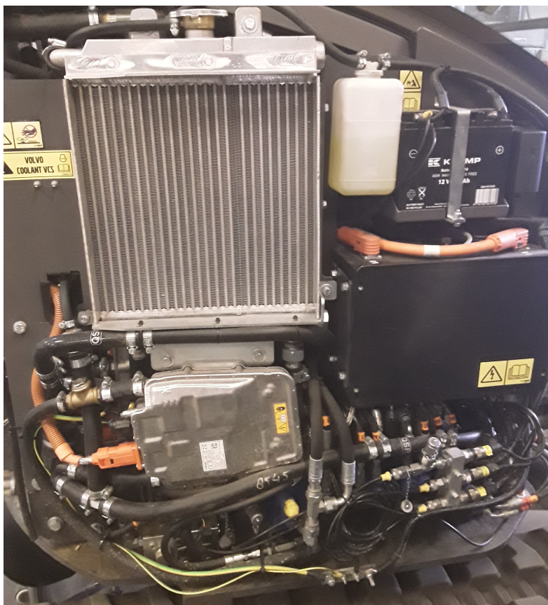
Figuur 6.13 Oranje HV-bedrading - zijkant machine
