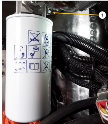
Figuur 6.11 Hydraulisch oliefilter vervangen
