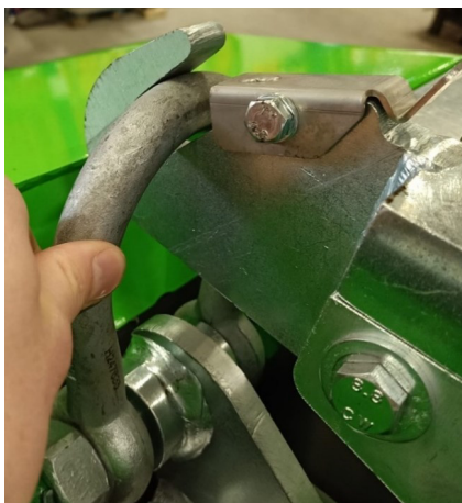
Figur 5.9 Batteripakke i løfteøye
