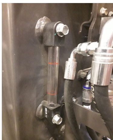
Figur 6.10 Kontrollrør for hydraulikkoljenivå
