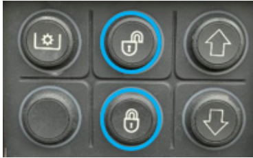
Figuur 5.16 Beide sloten vergrendeld
