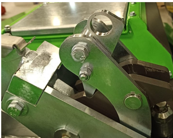
Figuur 5.7 Bewegingsrichting hefarm gewijzigd
