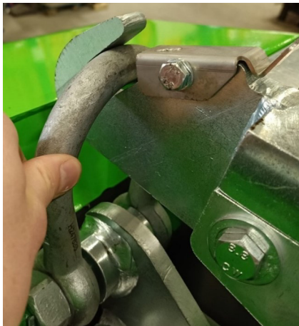
Figuur 5.9 Accupakket in hijssoog
