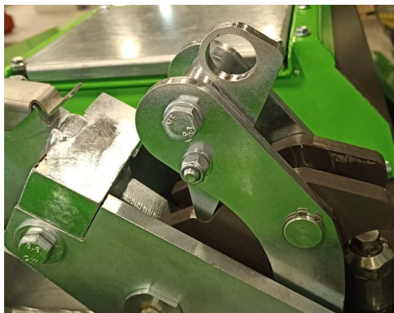
Figuur 5.7 Bewegingsrichting hefarm gewijzigd
