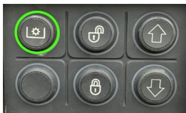
Figuur 5.13 Knoppenkast - actief
