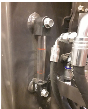
Figuur 6.17 Controlebuis peil hydraulische olie
