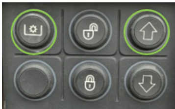
Figuur 5.4 Knoppenkast - power pack omhoog
