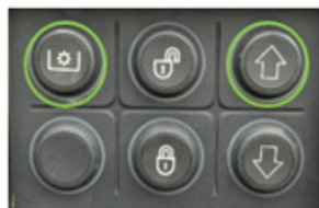
Figur 5.13 Knappeskap - batteripakk opp
