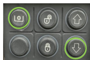
Figur 5.14 Knappeskap - batteripakk synker
