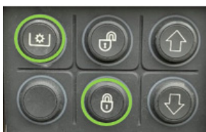
Figur 5.8 Knappeskap - Batteripakk låst
